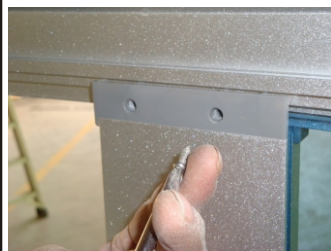
20. Fest aluminiumsrammen med M6X25 Bolter/muttere
