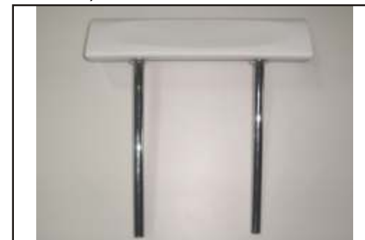
4. Finn frem den andre stanga som er uten skråhakk, ta på silikon og skru den forsiktig inn i det andre putehullet. Sjekk at den er vinkelrett.
