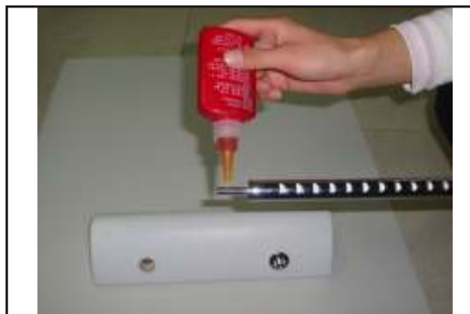
2. Finn frem stanga som har skråhakk. Ta på transparent silikon på skruedelen på stanga (del 3)
