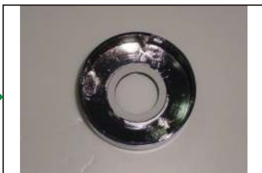
7. Plassér lys O-pakningsfølger i midten, på belagt dekselring. Sørg for at rillet side vender mot mørk O-ring.
