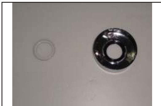
6. Plassér mørk O-ring i sporet i midten av belagt dekselring.
